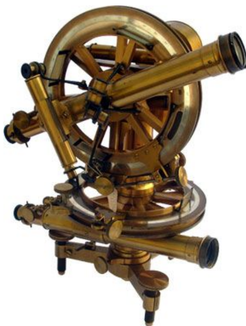
Teodolito, aparelho ótico usado para medir ângulos horizontais e verticais. (Créditos : Acervo/ MAST)
