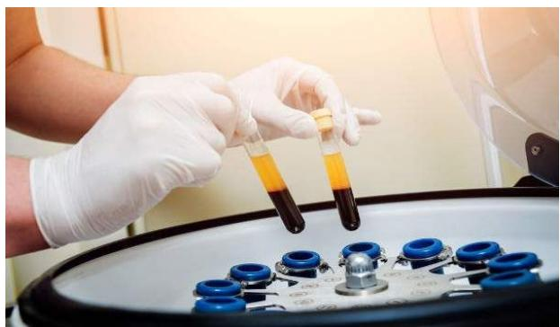
No processo de centrifugação, as pequenas partículas sólidas, dispersas em líquido, podem ser separadas. No final da centrifugação, as partículas sólidas ficam no fundo do recipiente, como mostrado na imagem a seguir.
