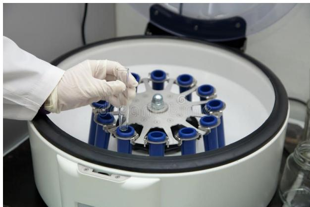
A mistura é colocada no centrifugador. Após ligá-lo, a mistura sofre rotações em alta velocidade, como mostrado nas figuras abaixo.
