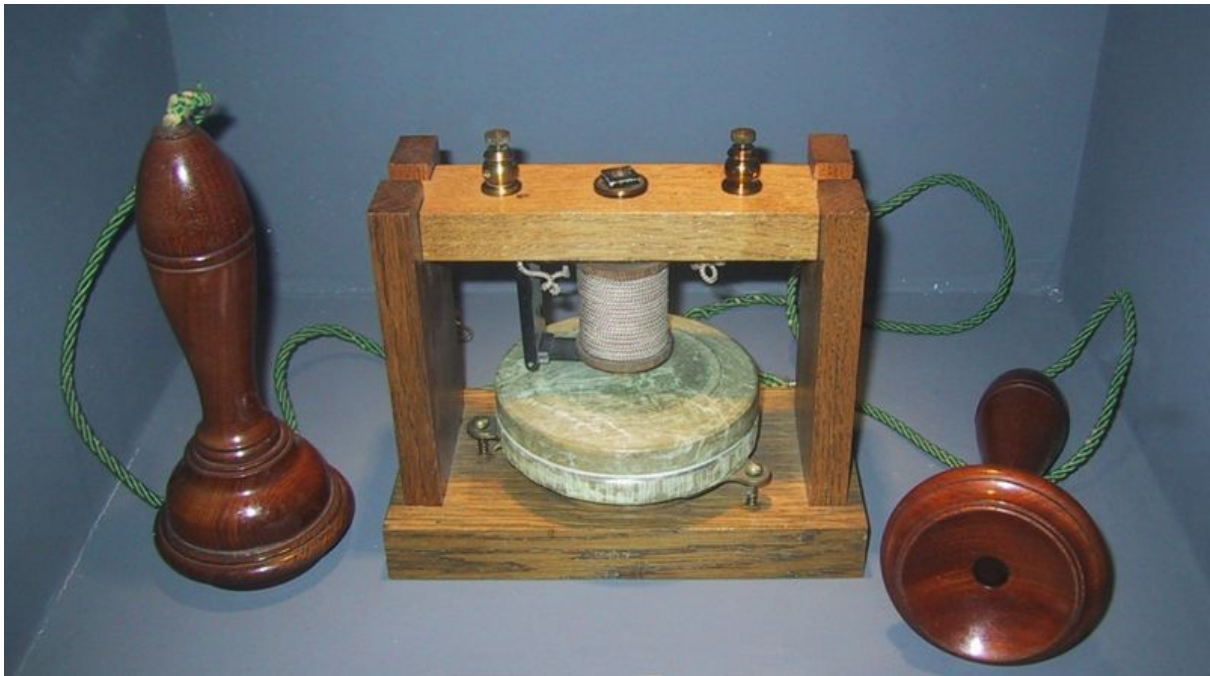
Fonte da imagem 1: Wikimedia Commons. Modelo do primeiro telefone receptor/ transmissor inventado pelo cientista norte-americano Alexander Graham Bell em 1875. Disponível em
