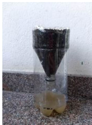
Figura 10. Armazenagem da água infiltrada no recipiente com substrato de jardim.
