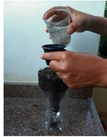
Figura 8. Simulação da precipitação no recipiente com substrato de jardim.
