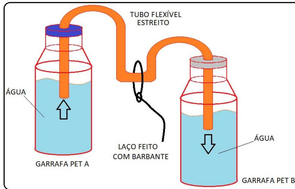
Observação: O tubo não deve ser fixado muito "justo" à tampa, impedindo entradas e saídas de ar, pois a diferença de pressão do ar poderá sobrepujar a diferença da pressão hidrostática e o sistema não funcionará.
