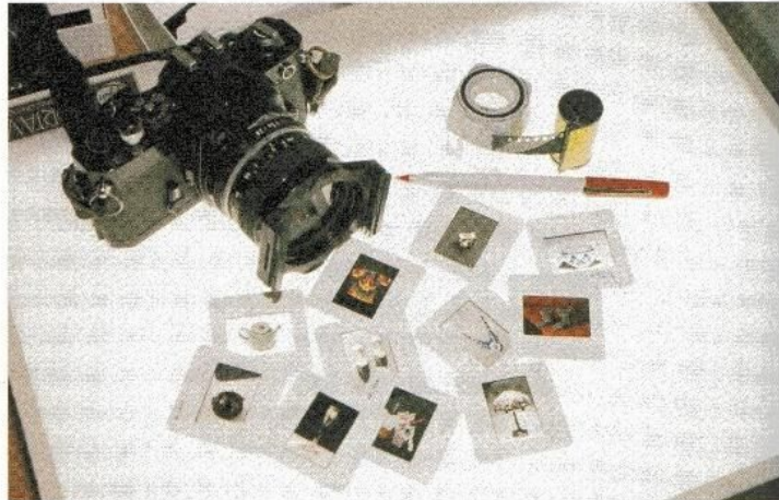
Câmara fotográfica e diapositivos. As diapositivos são imagens positivas, com diferentes formatos. Para a sua visualização, necessita-se de uma mesa de luz ou de um projetor e uma tela para a sua visualização. Possuem grande qualidade de imagem e, por isso, são muito utilizadas em artes gráficas.
