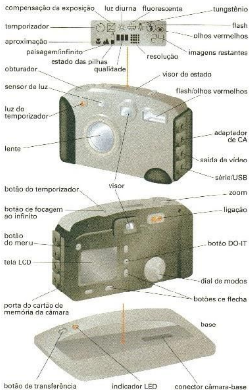
Corte transversal e partes de uma câmara digital. Uma câmara digital não usa filme, e sim um conjunto de sensores em forma matricial (CCD) que transformam a luz em cargas elétricas. A qualidade da imagem está diretamente relacionada ao número de pontos da matriz (pixels).
