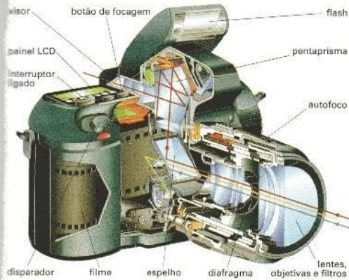
Corte transversal de uma câmera reflex. Estas câmaras possuem um mecanismo, baseado em lentes e espelhos, que permite enquadrar a imagem com exatidão e ajustar o diafragma e o tempo de exposição, em função do movimento do objeto e da intensidade da luz.
